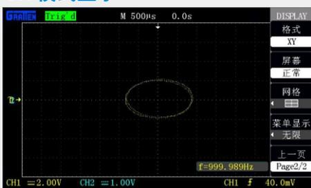
使用XY格式来分析相位差，此模式下将数据显示为点显示。
